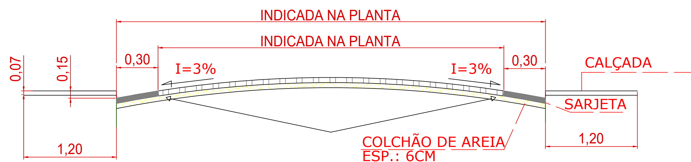
SEÇÃO TRANSVERSAL PARA PAVIMENTAÇÃO EM BLOQUETES
